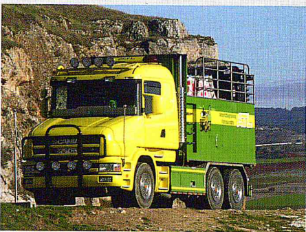
Bild 13: Hydroseeder, Gerät zur Ausführung von Anspritzbegrünun- gen
